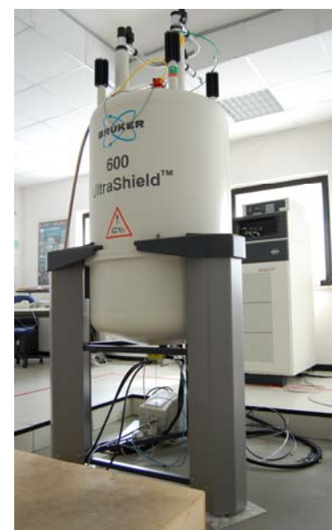
Fig. 1—Spettrometro a Risonanza Magnetica Nucleare presente nel laboratorio Analsi Chlmiche del COTIR
